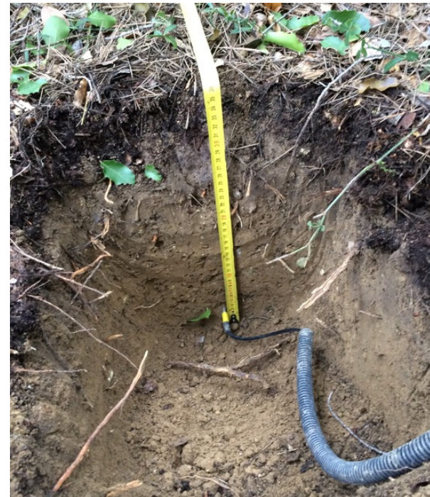
Capteurs humidité des sols (EC5 puis TEROS 12)
