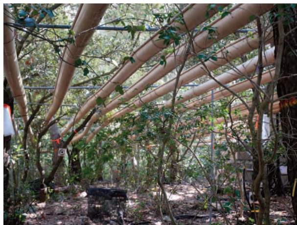
Dispositif de captation de l'eau de pluie pour simuler l'effet des sécheresses sur le site de Fontblanche à Ceyreste (13).
