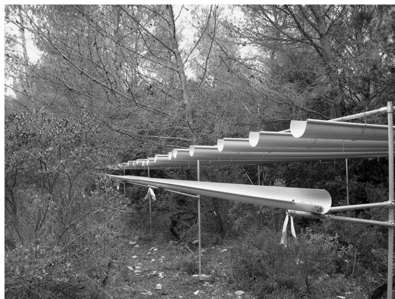
Photo 8 : Système d'exclusion d'eau de pluie dans un peuplement de pin d'Alep sur le site expérimental de Fontblanche (Bouches-du-Rhône). Photo D.A.
