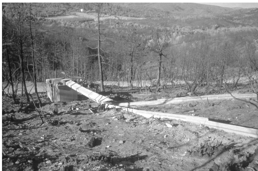
Photo 1 : La parcelle expérimentale en septembre 1990. Cette vue montre la partie inférieure du champ expérimental, la gouttière qui assure l'évacuation des eaux de ruissellement superficiel et des matériaux érodés, et les cuves réceptrices
