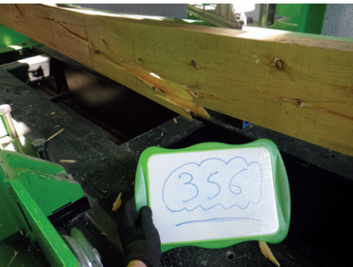
Photos 6, 7 et 8 : La machine de test à la rupture en fonctionnement.
