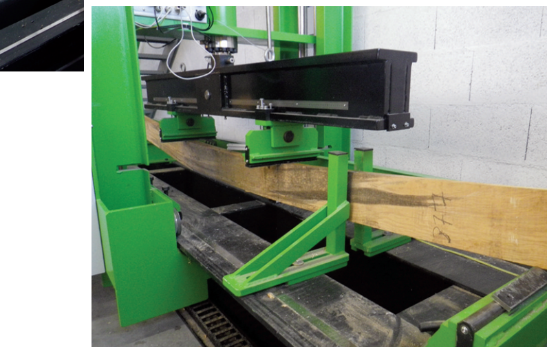
Photos 6, 7 et 8 : La machine de test à la rupture en fonctionnement.
