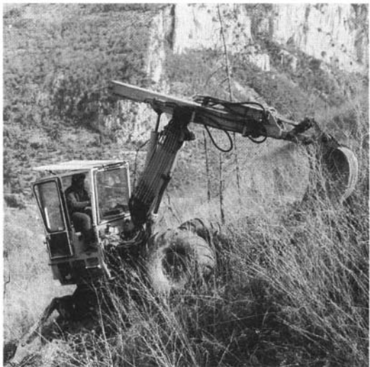
Photo 4 : La pelle araignée opérant en pente montante. Noter la vigueur des pentes Photo A. Dagorne
