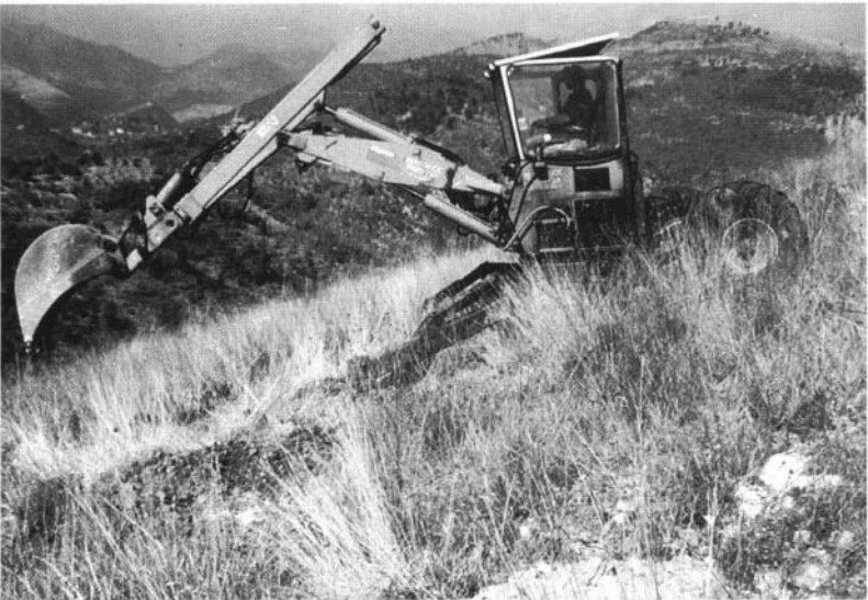
Photo 3 : La pelle araignée opérant en pente descendante Photo O. Roussel
