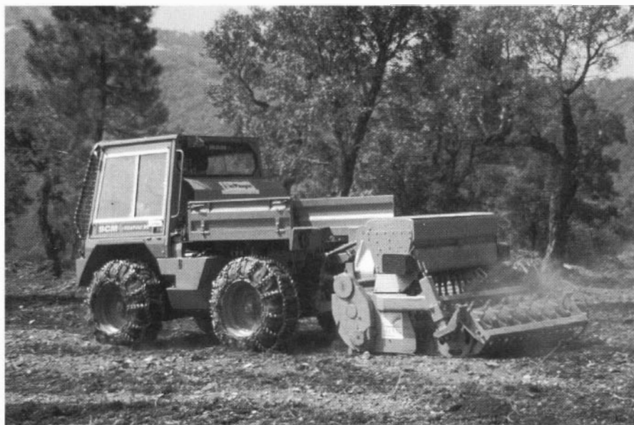
Photo 11 : Dessouchage, fertilisation et sursemis avec le DUTZI.
