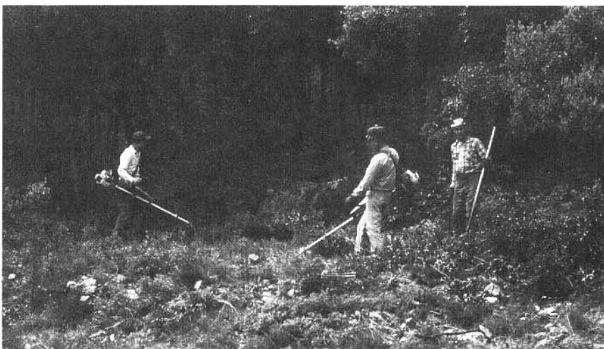
Photo 3 : De petits matériels permettant de débroussailler de manière sélective. Photo J.B.
