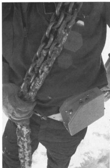
Télécommande de treuil facilitant les manœuvres de débardage. Photo CFPA, La-Bastide-des-Jourdans
