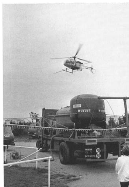
KAAF agroaviation : équipement d'hélicoptère pour la lutte contre l'incendie. Photo L. B.
