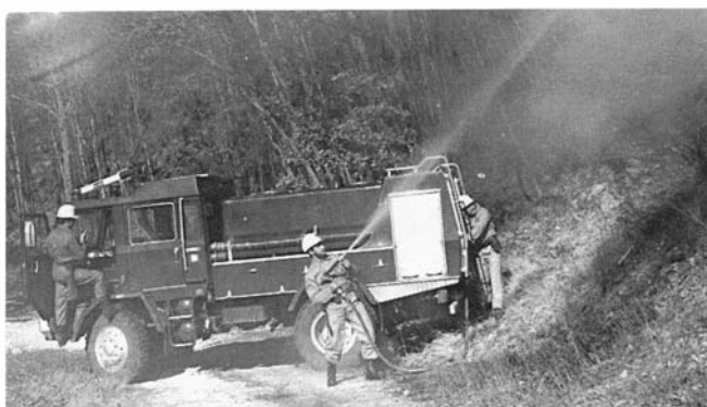
Photo 2. Camion-citerne tout-terrain du CFS; capacité 3 000 litres.
