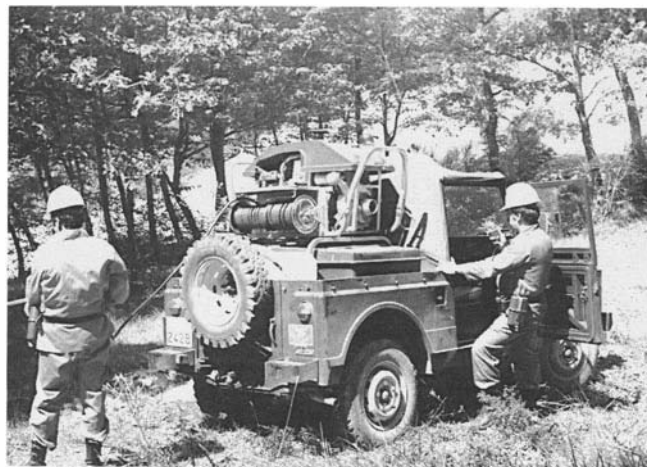
Photo 3. Campagnola FIAT du CFS, avec motopompe et réservoir 400 litres.
