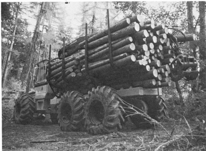
Photo 9. Porteur Cemet-Agrip SM 842 B 120 CV grue 6t.m.
