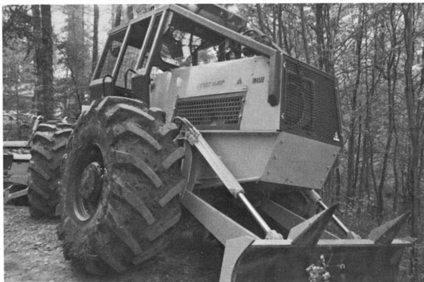
Photo 4. Debusqueur Cemet-Agrip 4500, moteur 160 CV, 6 cylindres, gros pneus 23.1.26. 2 treuils 11 t. Photo C.S.
