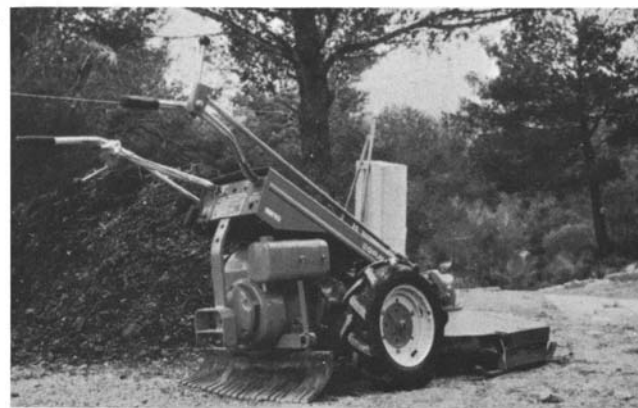
Photo 5. Débroussailleuse de type « motoculteur ». Photo F.B.
