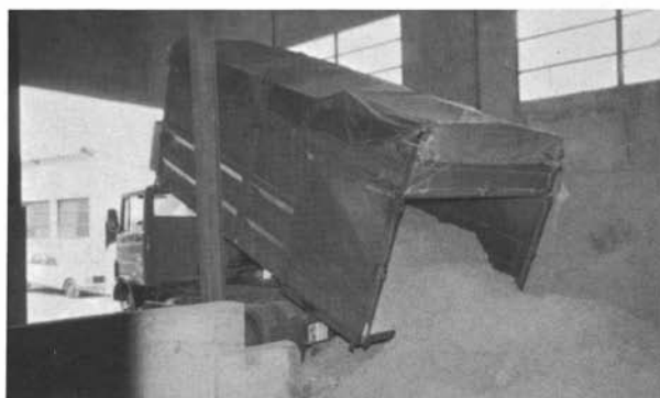
Photo 6. — Livraison dans un silo de 600 m 3 par un petit camion avec aspirateur; capacité 20 m 3 .
