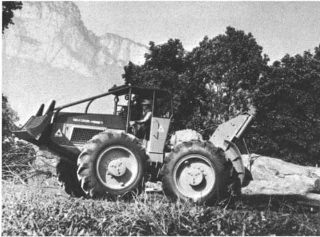
Photo 9. — Tracteur débusqueur - Skidder : 4 roues motrices égales, articulation centrale, treuil, lame avant, protection du conducteur : Renault-Cimet SM 368 C de 85,4 kw.
