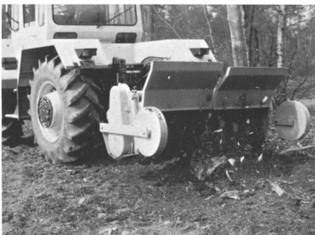
Photo 4. – Les houes rotatives renforcées débroussaillent et incorporent au sol la couche superficielle d'humus (Rotadairon).
