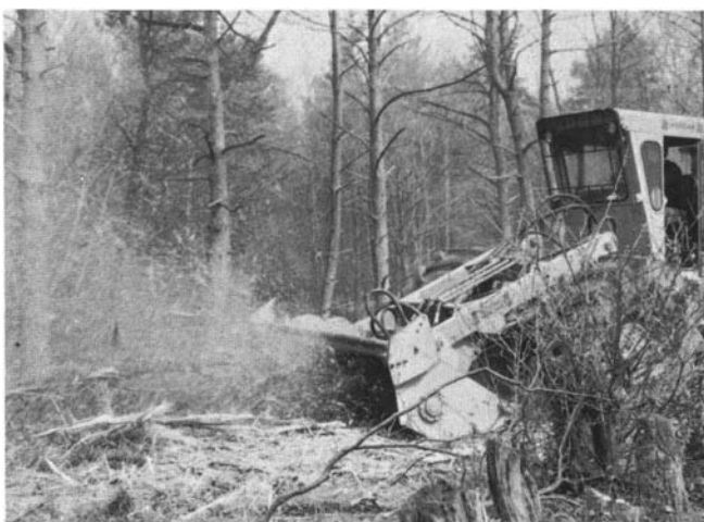
Photo 5. – Débroussailleur à rotor à axe horizontal, porté sur bras hydraulique frontal qui peut débroussailler et déchiqueter la végétation (Hydro-AX).
