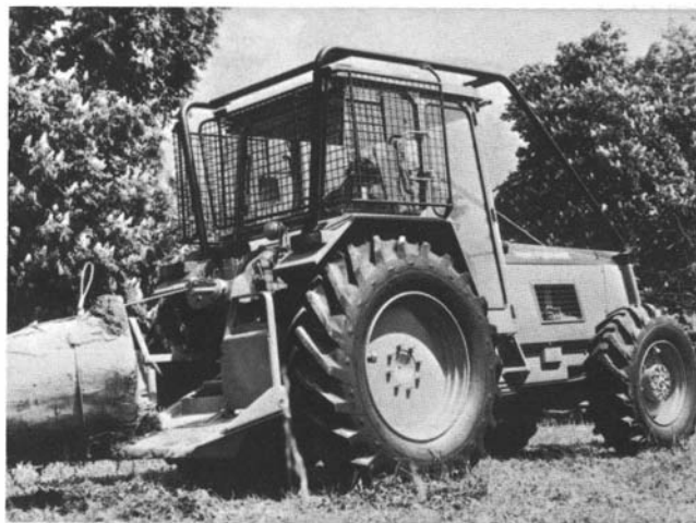
Photo 8. — Tracteur forestier débusqueur à 4 roues motrices type agricole transformé en forestier : Treuil - bouclier - cabine protégée - arceau de protection et d'écartement des branchages : Renault-Cemet SM 255 de 65,5 kw, à châssis rigide.
